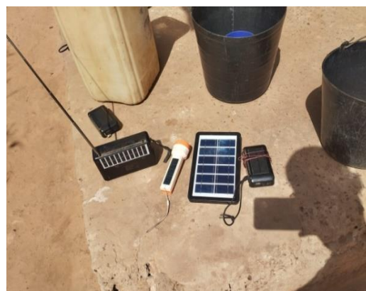
Figura 20 -Lanterna e rádio incorporando painel e acumulador de carga.
