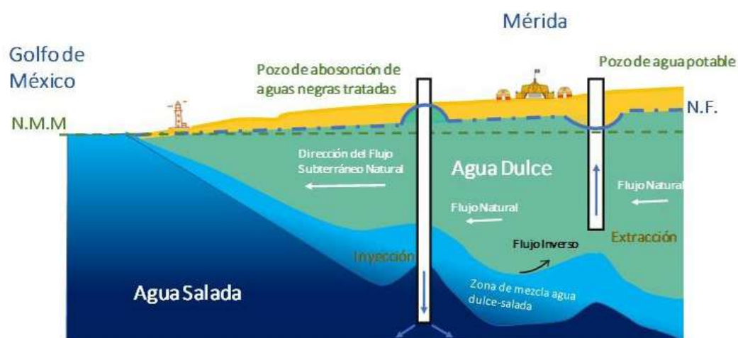
Figura 1. Esquema del comportamiento del agua subterránea en pozos de descarga y extracción respecto al nivel del mar de Yucatán.
