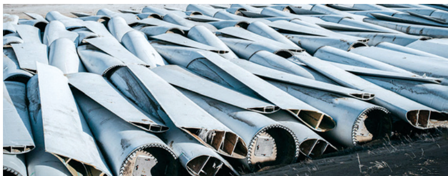
Figura 1. Depósito en vertedero de palas de aerogenerador
