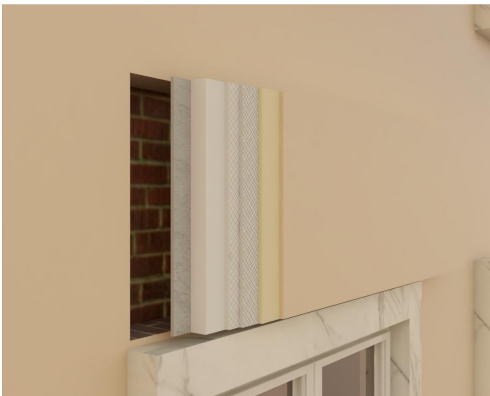
Figura 4.21 - Modelo 3D – aplicação de sistema ETICS.
