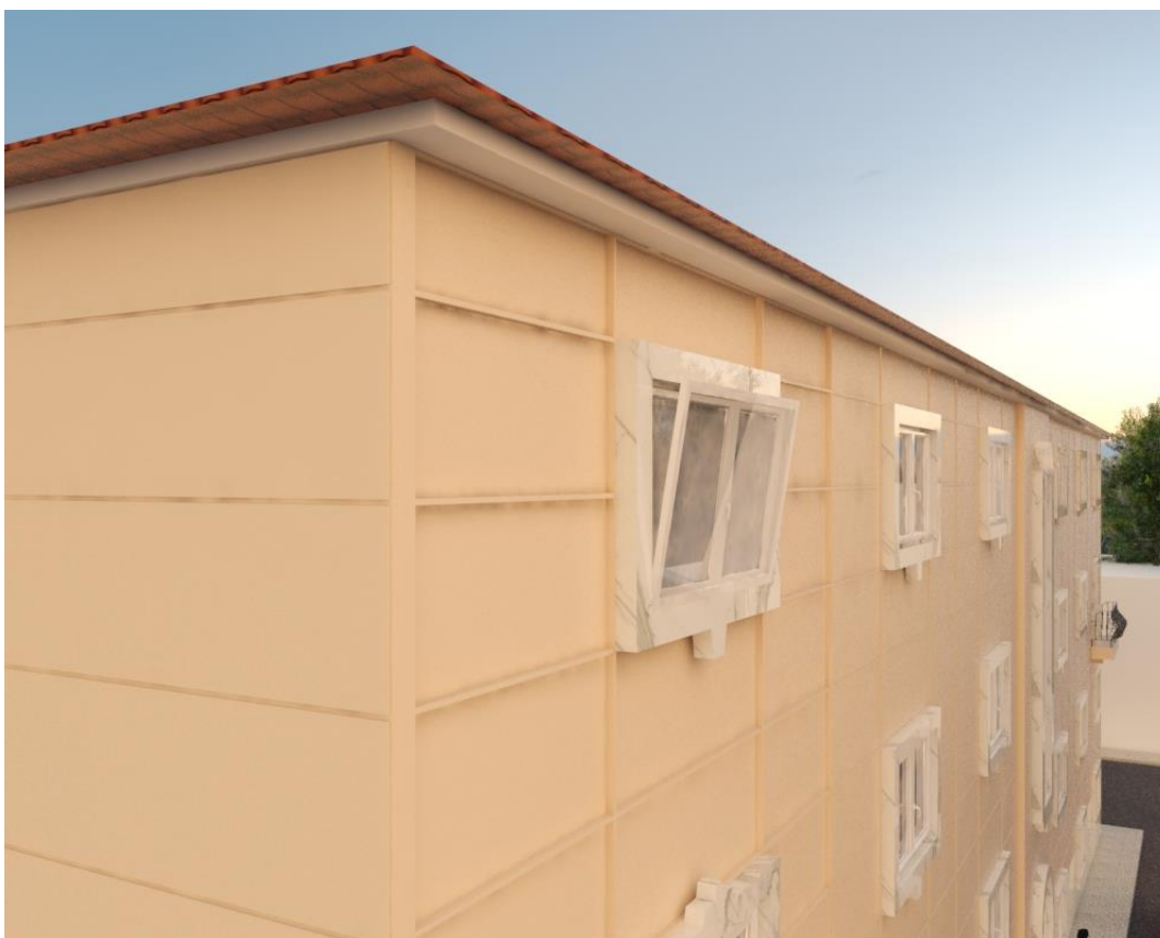
Figura 4.20 - Modelo 3D – aplicação da solução storm window
