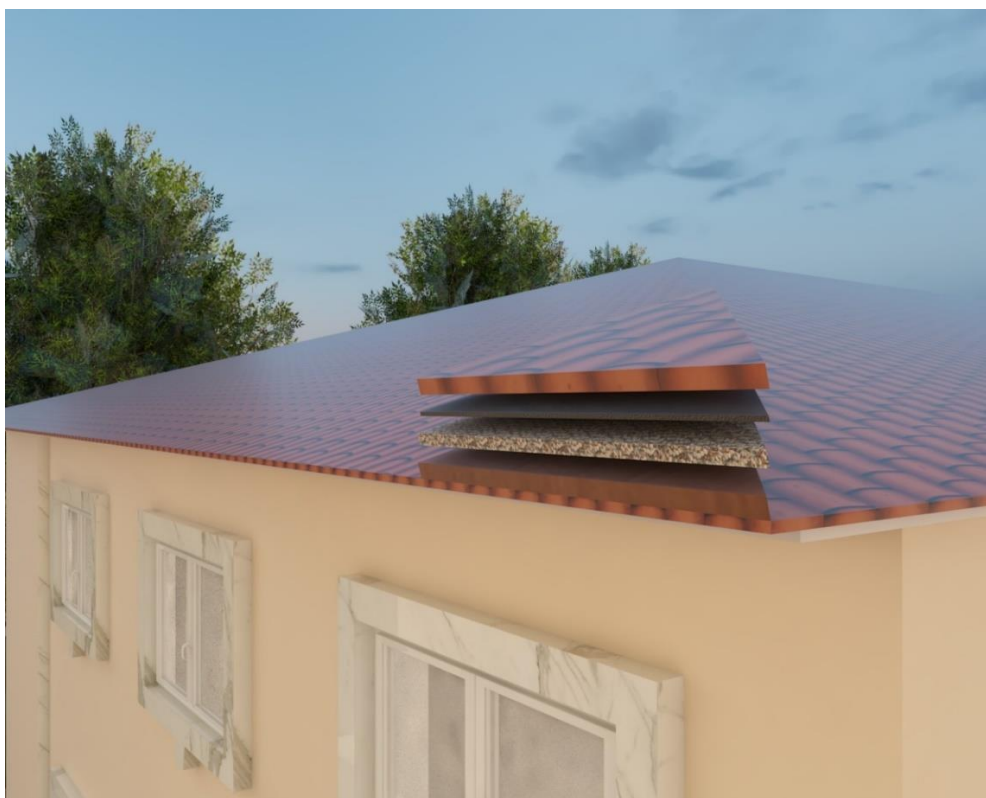
Figura 4.22 - Modelo 3D – aplicação de camadas da cobertura.
