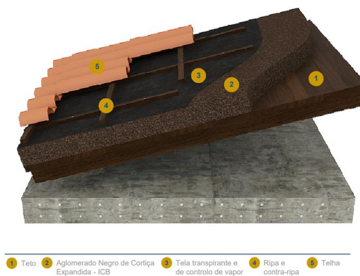
Figura 2.6—Sistema de isolamento térmico e acústico para coberturas inclinadas. ( https://www.csustentavel.com/ecoproductos/ )
